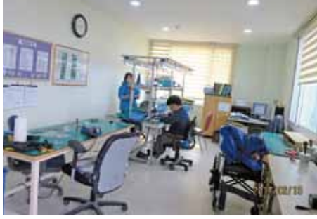
写真22: 電子部品の組立。車いすが自在に移動できるスペースが必要であることが理解できる。
