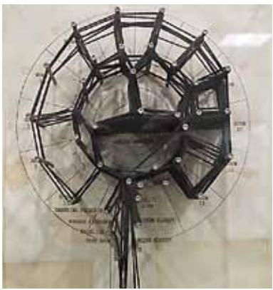
写真42:ロチェスター・メソジスト病院が1957年に全米で初めて導入した環状ICUにおけるナース動線軌跡。ナースステーションを中心にして周辺に12の個室が配置された。ナースの移動軌跡が効率的であることを鉄線で示している。
