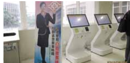
写真18: 自動缴费機(自動支払機)。「缴费(きょうひ)」とは費用引き落としのこと。この機器では現金取り扱いはない。クレジットではなく銀行口座引き落とし(e-bill)のようだ。
